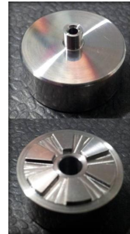
Konstruierte SEM-Flachventilbauteile für Laboranlage
